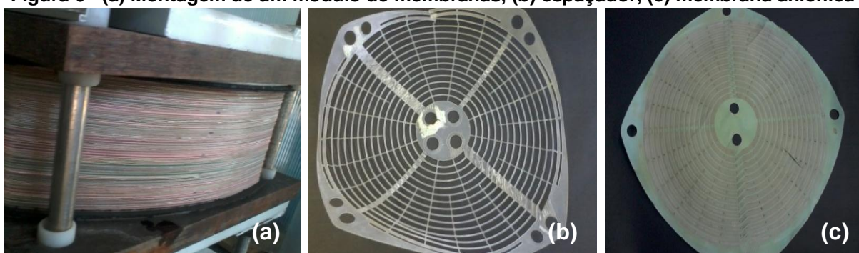
Figura 6 - (a) Montagem de um módulo de membranas, (b) espaçador, (c) membrana aniônica
