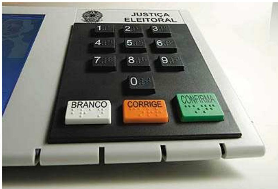
**Figura 1: Teclado de uma urna eletrônica com caracteres Braille.**
