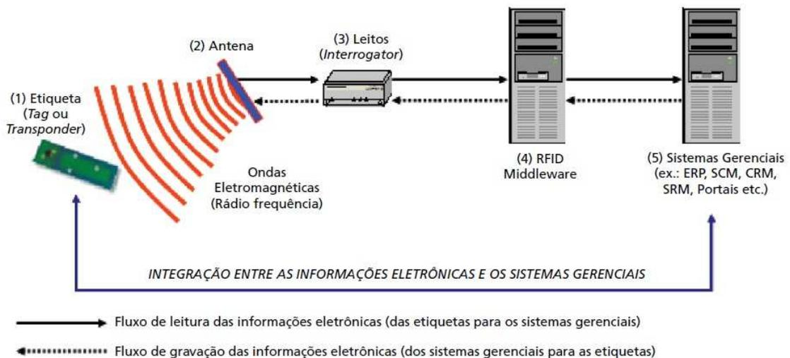
**Figura 15: Fluxograma de comunicação em um sistema RFID (PEDROSO, ZWICKER E SOUZA, 2009, p.16 ).**
