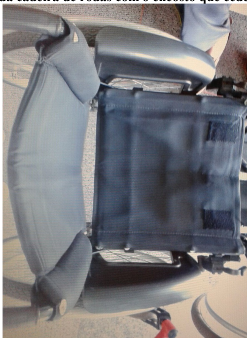
Figura 33 – Vista superior da cadeira de rodas com o encosto que cedeu após certo período de uso.
