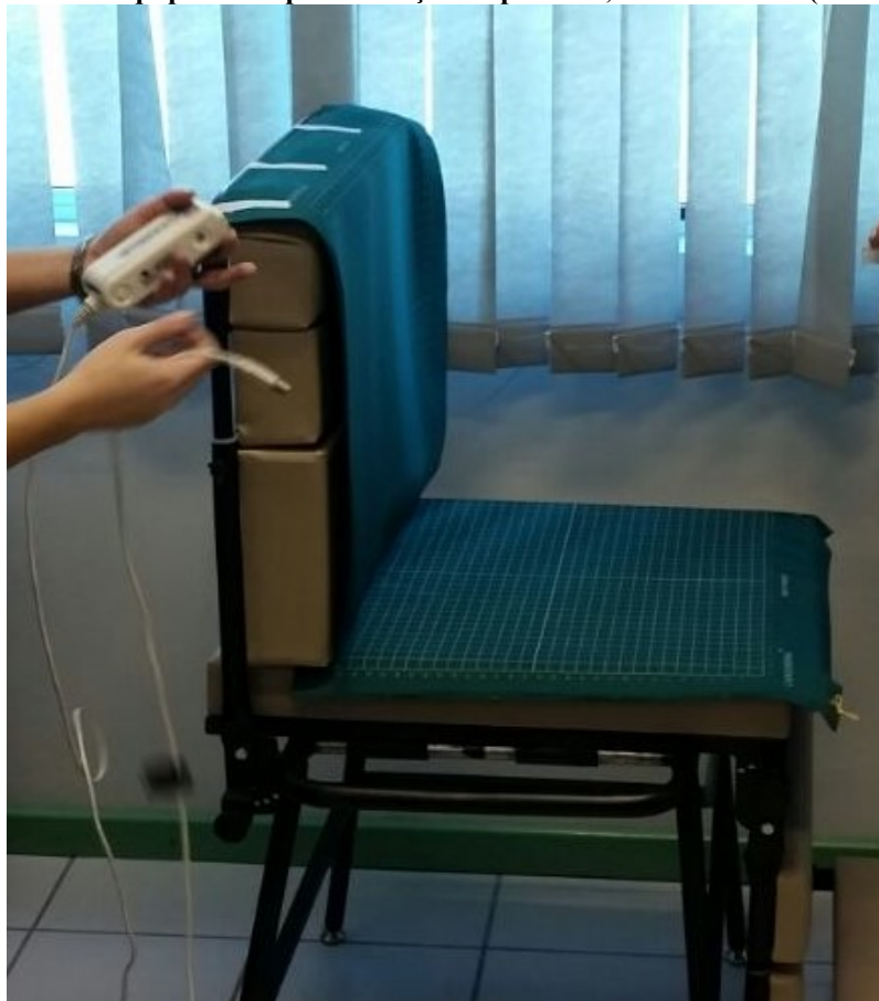
Figura 19 – Equipamento para medição de pressões, CONFORMat (Tekscan).
