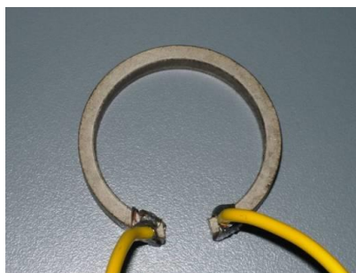
Figura 3.7 – Anel segmentado com terminais para medida da resistividade elétrica.
