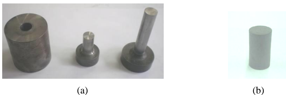
Figura 3.2 – Amostras na forma de cilindro – (a) Matriz – (b) Corpo de Prova.
