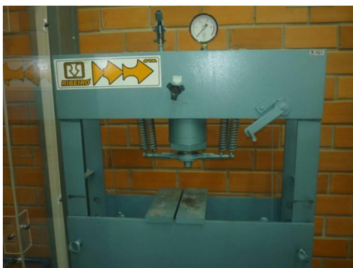
Figura 3.3 – Prensa hidráulica de 40 t – Laboratório de Mecânica – Feevale.
