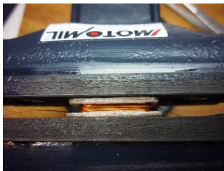
Figura 3.17 – Foto de uma bobina em processo de secagem.
