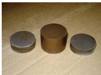
Figura 3.14 – Peças sinterizadas na forma de “tarugo” antes da usinagem.
