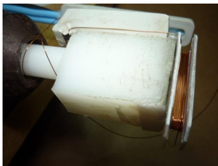
Figura 3.18 – Etapa de bobinagem, mostrando molde com carretel.
