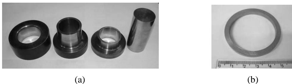
Figura 3.1 – Amostras na forma de anel – (a) Matriz – (b) Corpo de Prova (régua em cm).
