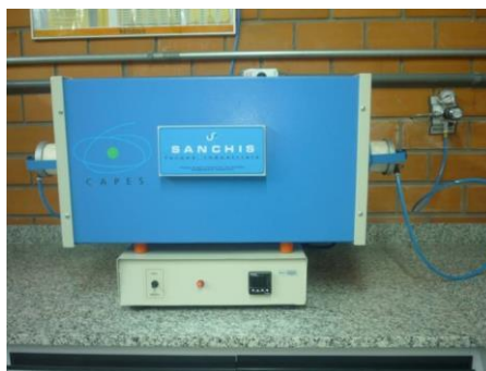
Figura 3.5 – Forno elétrico utilizado para a sinterização - Lab. Mecânica – Feevale.
