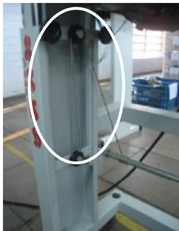
Figura 17: Regulagem de altura para máq. de costura. (Fonte: Setor de Costura, 2010).
