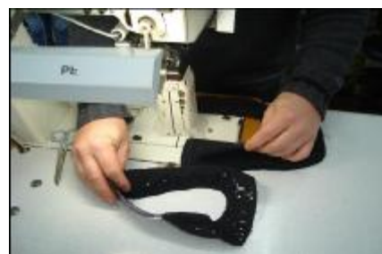
Figura 13: Processo de costura: largar. (Fonte: Setor de Costura)
