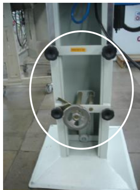
Figura 16: Regulagem de altura para prensas. (Fonte: Setor de Costura, 2010).
