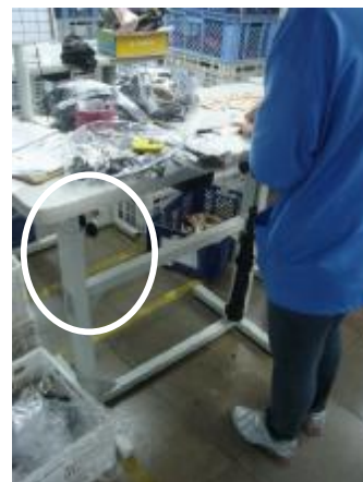
Figura 18: Regulagem de altura para mesas. (Fonte: Setor de Costura, 2010).
