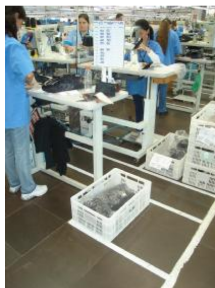
Figura 22: Demarcação do local das caixas. (Fonte: Setor de costura, 2010).
