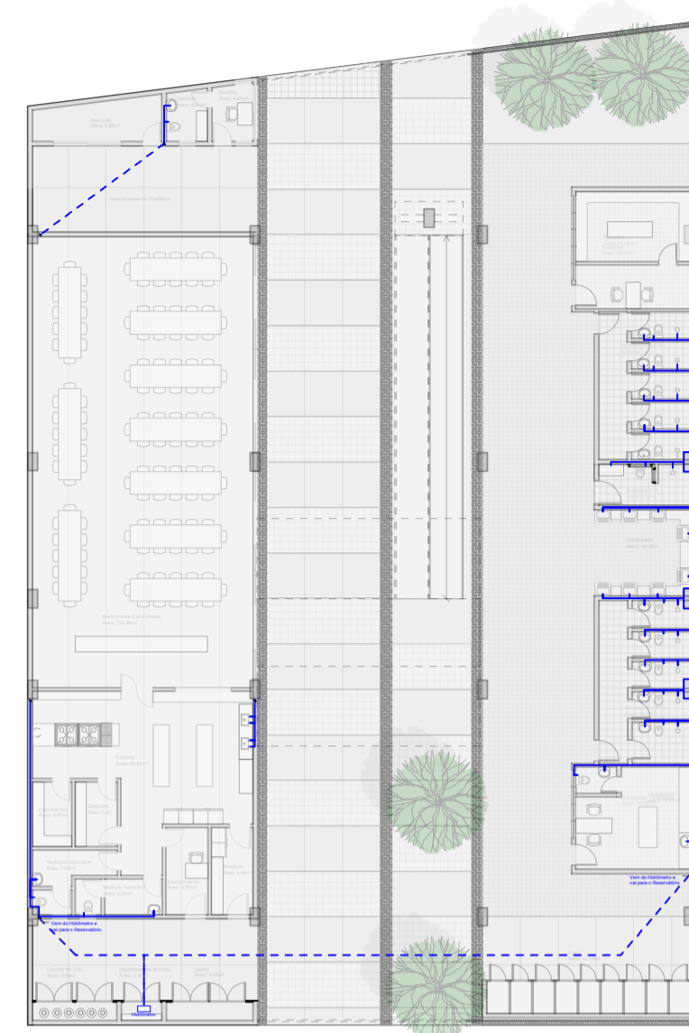
PLANTA BAIXA HIDRAULICA - PAVIMENTO TERREO Escala: 1/200
