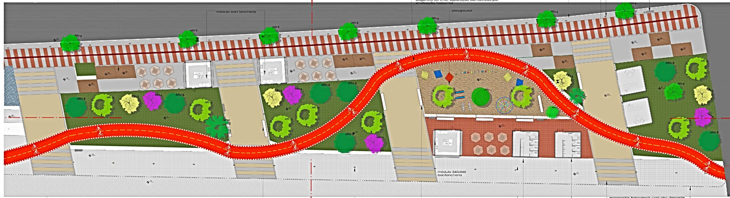
ciclofaixa bidirecional, composta por asfalto poroso pigmentado de vermelho (conforme exigência do CTB), separação demarcada por sinalização horizontal
