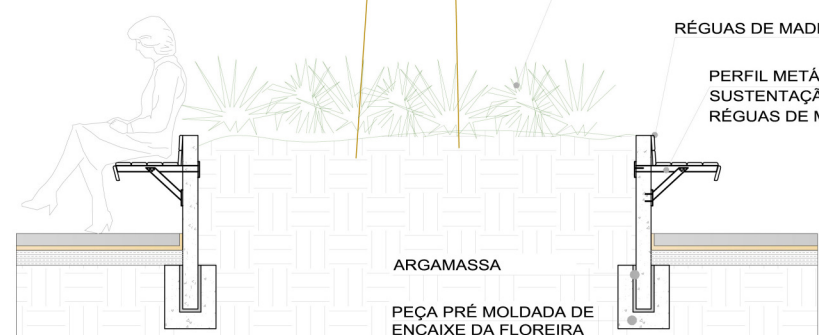
D3 - DETALHE CANTEIRO PARA VEGETAÇÃO COM BANCO (REFERENTE A AMPLIAÇÃO 2 PRANCHA 5) ESCALA : 1/25
