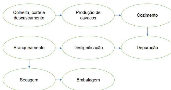
Figura 3: Fluxograma da produção da celulose.
