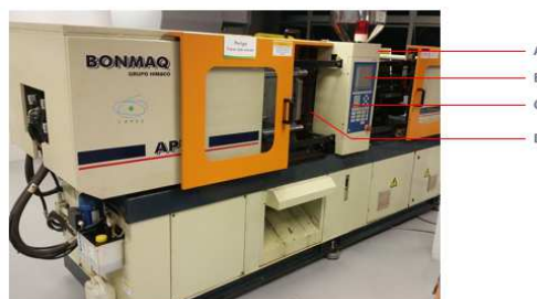
Figura 16: Injetora APTA 80, marca Bonmaq, e regiões A, B, C e D do perfil de temperatura.
