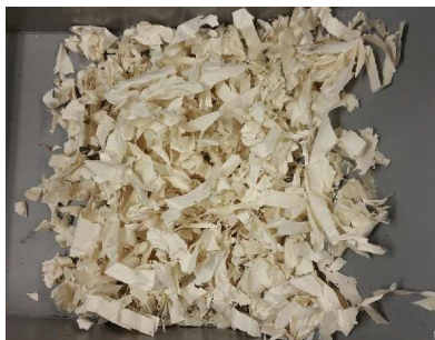
Figura 9: Papel triturado após primeira etapa de cominuição em um triturador industrial.
