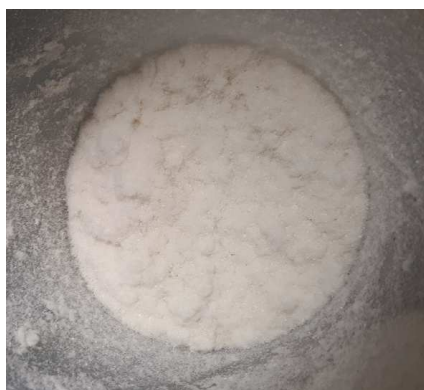
Figura 14: Papel resinado após micronização.
