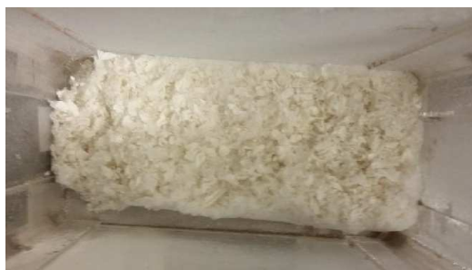
Figura 11: Papel após segunda etapa de cominuição em moinho de facas de bancada.
