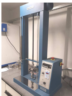
Figura 17: Dinamômetro da marca Maqtest, utilizado para a realização dos ensaios de resistência à tração.
