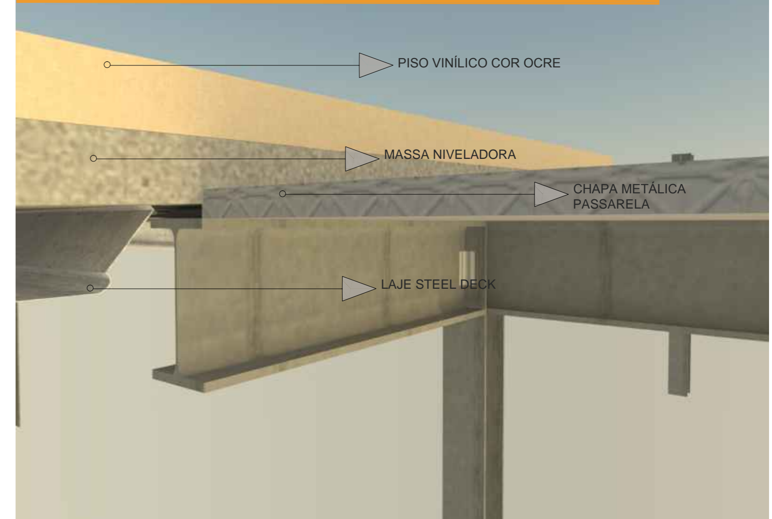
DETALHE APOIO VIGA EM ALVENARIA
