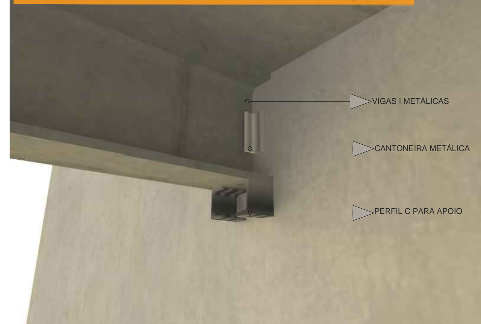
DETALHE APOIO VIGA EM ALVENARIA
