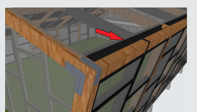
DETALHE CALHA EMBUTIDA
