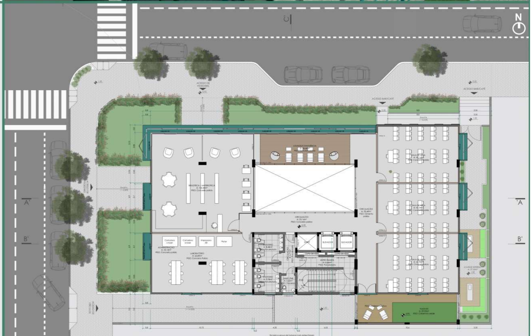
PLANTA BAIXA PRIMEIRO PAVIMENTO ESC: 1/125 ÁREA: 489,05m 2
