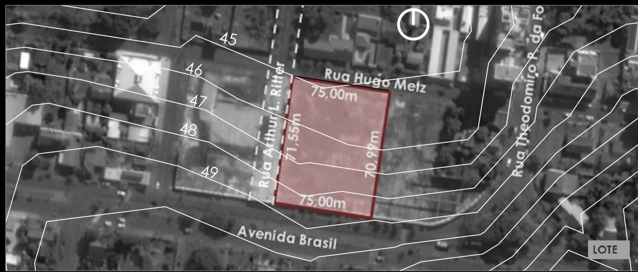
Aproveitamento do desnível para implantação do estacionamento, projetando a biblioteca para a esplanada
