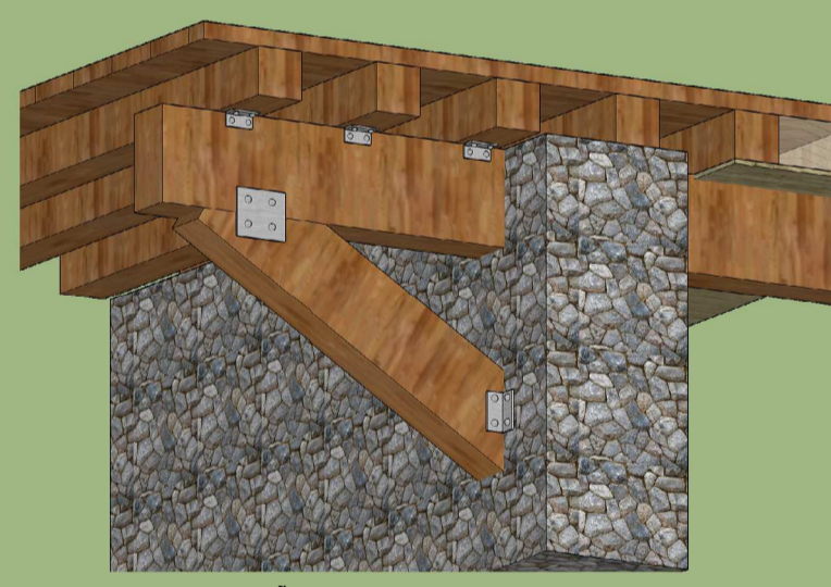
EXEMPLO DE CONEXÃO ESTRUTURAL
