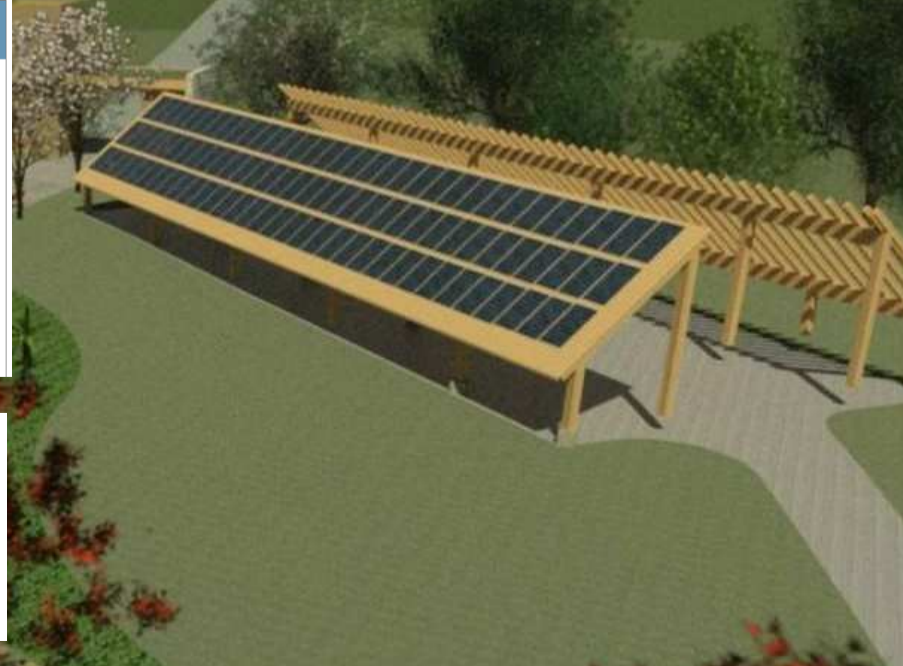
ESTACIONAMENTO - COBERTURA COM PLACAS FOTOVOLTAICAS - 10
