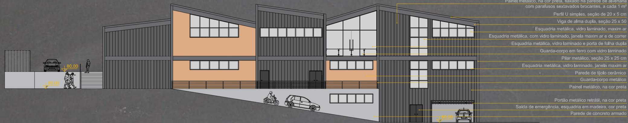
Painel metálico, na cor preta, fixado na parede de alvenaria com parafusos sextavados brocantes, a cada 1 m<sup>2</sup>
