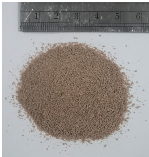
Figura 12: Resíduo termofixo de EVA micronizado e peneirado
