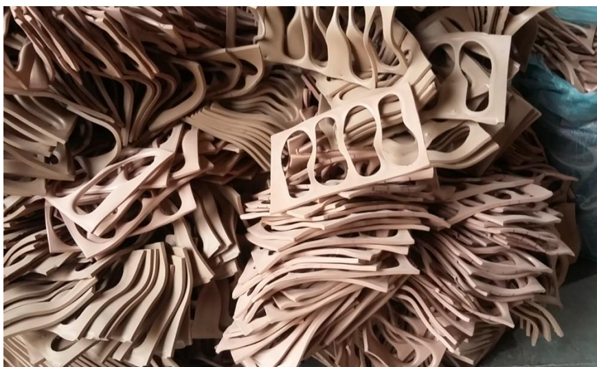
Figura 8: Resíduo da indústria calçadista proveniente de palmilhas de EVA expandido
