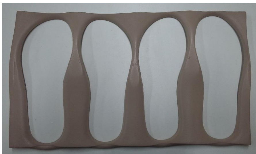
Figura 9: Esqueleto da palmilha conformada de EVA expandido
