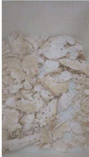
Esta não formação de membranas está relacionada a concentrações elevadas de sódio que reduzem a estabilidade da precipitação polimérica (no caso SPPO com NaOH) causando uma aglomeração de partículas de polímero, impedindo a formação de membranas (MACHADO; LIMA; PINTO, 2007).
