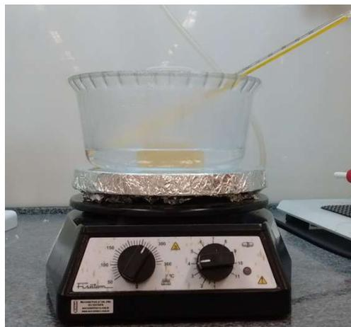
Visando a preparação de membranas, o SPPO dissolvido foi vertido em uma placa de vidro para formar filmes de 10x10 cm, conforme as figuras 18a e 18b, com posterior aquecimento de 24h a 60°C em estufa (método casting) (CORTE, 2017; GONG et al., 2007). Membranas de 50x50 cm também foram preparadas posteriormente, de acordo com figura 19.
