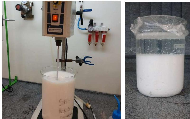
**Figura 33a e 33 b– Processo de lavagem de SPPO**
