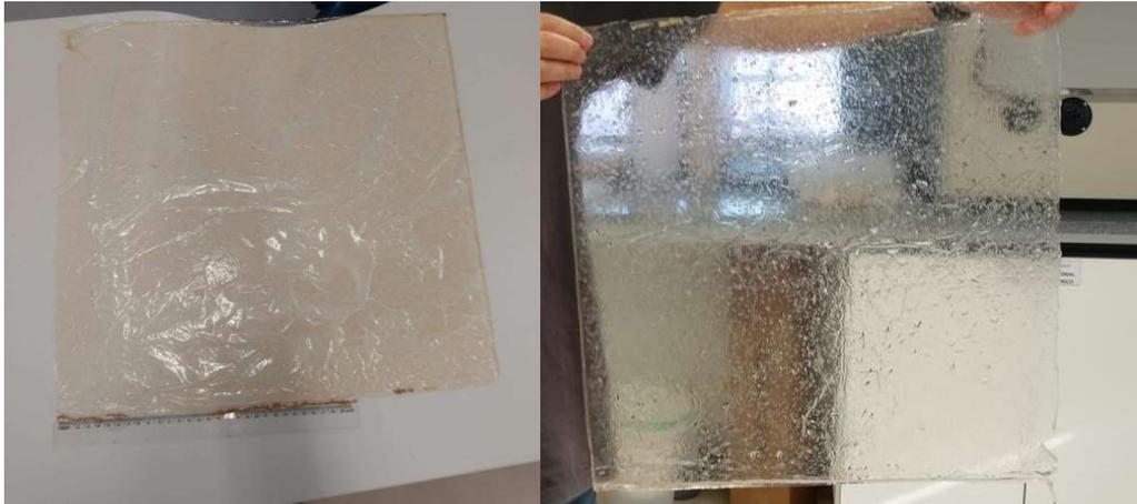
As membranas catiônicas de 100 cm<sup>2</sup> apresentam dimensões apropriadas para uso em células de eletrodialise em escala laboratorial, já as membranas de 2500 cm<sup>2</sup> foram produzidas com o objetivo de avaliar a confecção de membranas com dimensão em escala maior,
