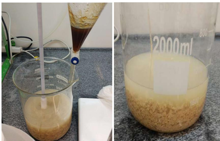
Após terminar de gotejar, deixa-se decantar e retira-se o metanol sobrenadante. Após secagem por 24 horas em capela de exaustão até não apresentar metanol aparente, reduz-se o tamanho do BPPO com pistilo e coloca-se em estufa para secagem a 60°C por 5 dias. O BPPO seco está apresentado nas figuras 25a e 25b.
