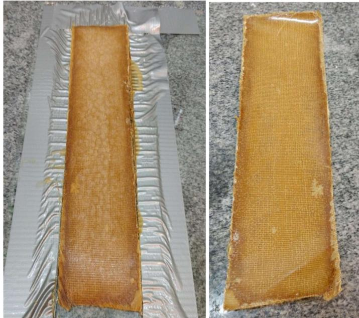
O reforço das membranas aniônicas foi realizado com dois tipos de tecidos: um à base de poliamida e outro à base de poliéster. As membranas com tecido de poliamida apresentaram ondulações no tecido à base de poliamida. Com o tecido à base de poliéster, as membranas ficaram lisas e sem ondulações, afetando positivamente os valores de em condutividade iônica por impedância eletroquímica e em CTI, conforme pode ser observado na seção 4.4 na página 98.
