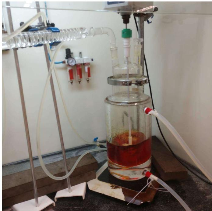
Após a montagem do sistema, 50% do clorobenzeno é adicionado ao balão ou reator. Assim que o clorobenzeno atinge a temperatura de 55°C, o agitador é ligado a velocidade de 20 rpm e então, adicionado lentamente o PPO (previamente pesado) para sua dissolução.
