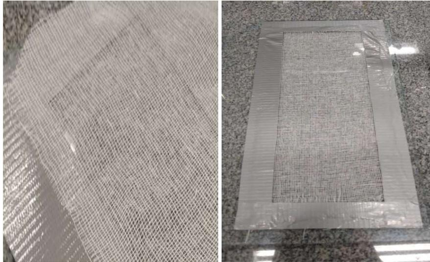
**Figura 27a e 27b – Dissolução do BPPO e preparação de membranas aniônicas sobre tecido**
