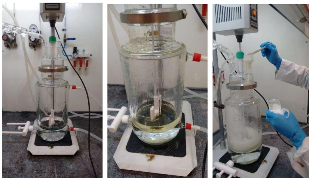
Após a montagem do sistema, 20% do volume total de clorofórmio definido para a reação é adicionada no balão ou reator. Após a adição lenta de PPO, ácido sulfúrico ( $\text{H}_2\text{SO}_4$ ) concentrado é gotejado durante 10 a 20 minutos, em velocidade constante, independentemente da fração molar PPO: $\text{H}_2\text{SO}_4$  considerada. Quando é finalizada a adição de  $\text{H}_2\text{SO}_4$ , o restante do clorofórmio é adicionado ao sistema.
