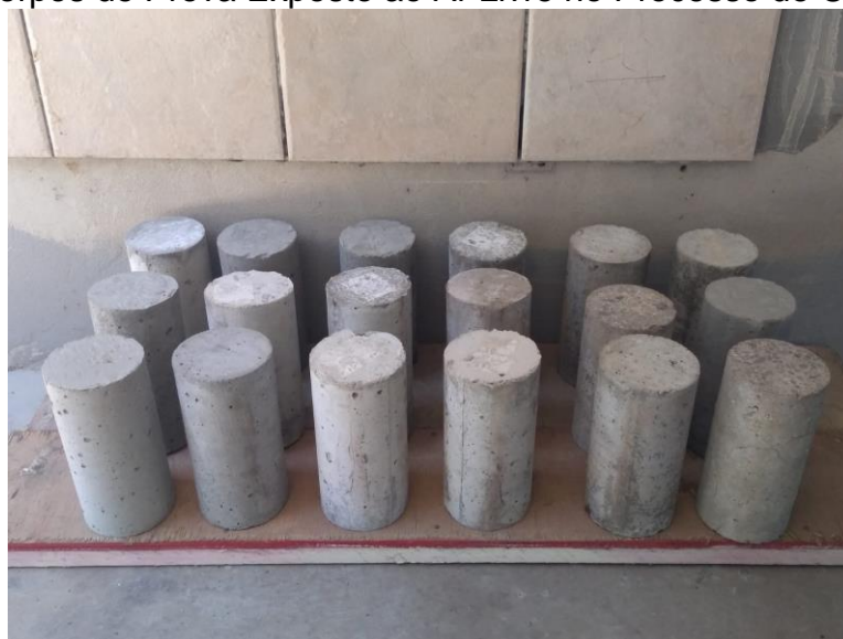
Figura 16: Corpos de Prova Exposto ao Ar Livre no Processo de Cura Alternada
