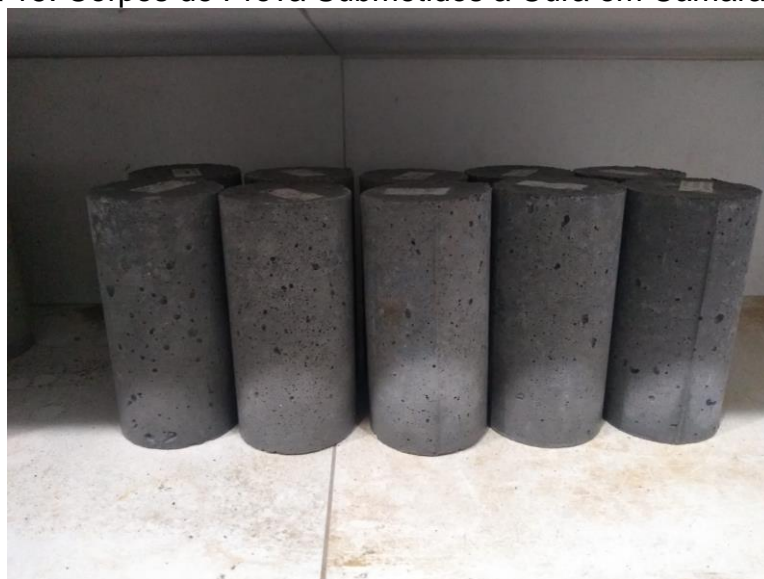
Figura 15: Corpos de Prova Submetidos a Cura em Câmara Úmida
