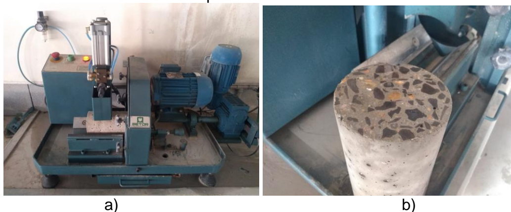
Figura 17: Processo de Preparação dos Corpos de Prova: a) Retifica Utilizada; Superfície Retificada
