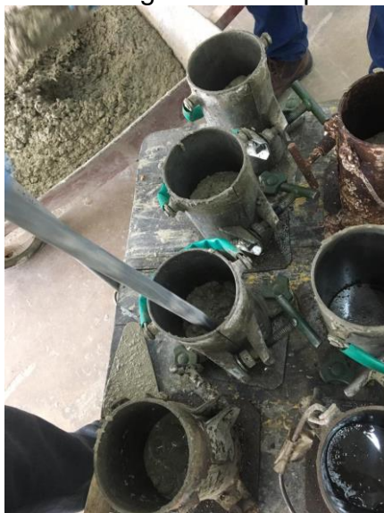
Figura 13: Moldagem dos Corpos de Prova
