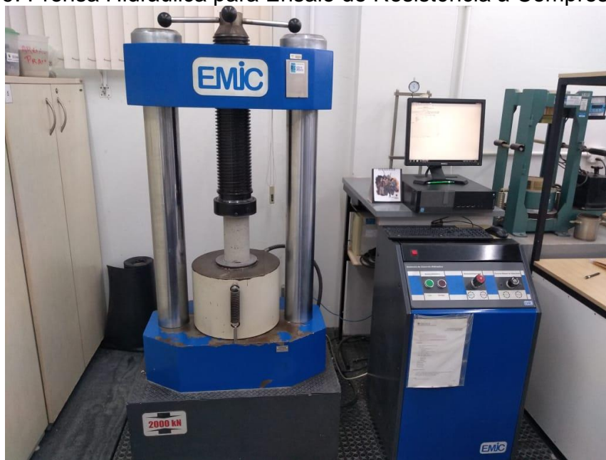
Figura 19: Prensa Hidráulica para Ensaio de Resistência à Compressão Axial
