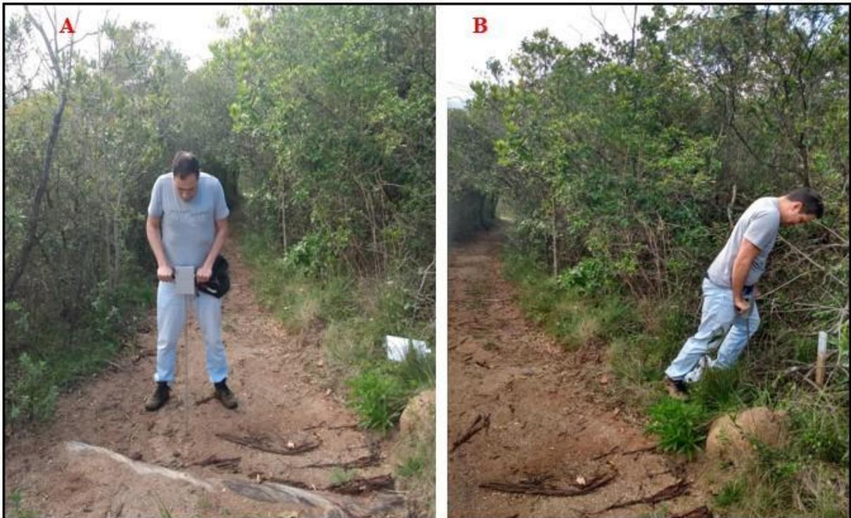
Figura 7: 7A. Medição da compactação do solo no centro da área de pisoteio; 7B. Medição da compactação do solo em um dos lados da borda. Imagens do acervo do autor.
