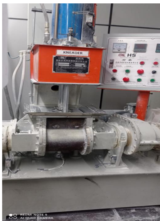
Figura 12: Misturados de eixo rotativo Kneader
