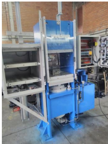
Figura 14: Prensa Hidráulica utilizada para confecção das placas expandidas de EVA
