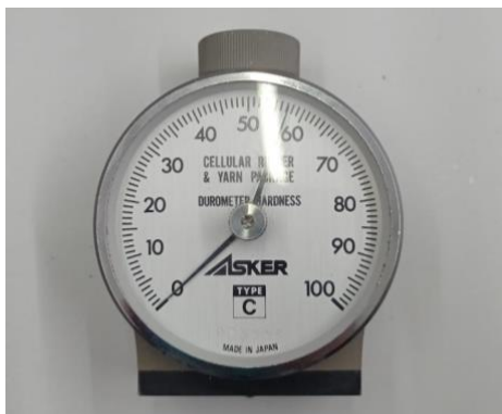
Figura 17: Durômetro tipo Asker C
