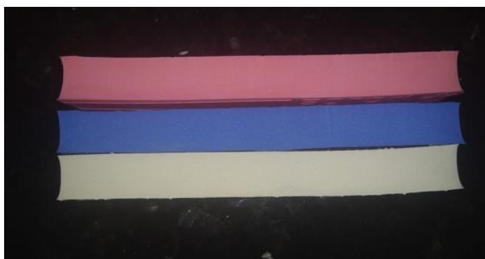
Figura 16: Imagem dos corpos de prova do ensaio de encolhimento da parte interna das placas
