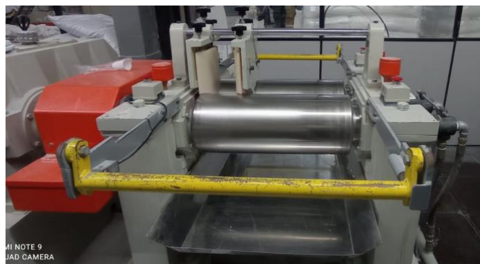
Figura 13: Cilindro de processo para melhorar a dispersão das matérias-primas
